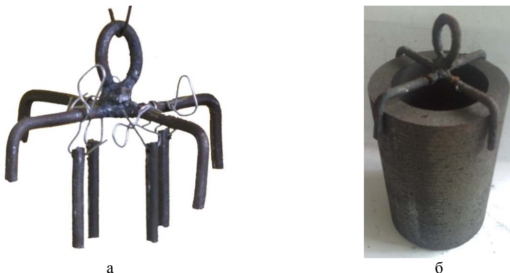
Рис. 1. Оснастка для проведения экспериментов по изучению скорости растворения стальных и чугуновых образцов в жидком алюминии:
